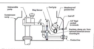
TANK TURBINE SUMP DETAIL
